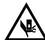
**Rischio di schiacciamento:** delle dita durante le manovre di inserimento dei dischi peso negli appositi depositi sul lato posteriore
